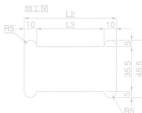
※取付は、専用の裏版で挟み込みますので、掘込み穴は貫通して下さい。
