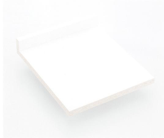
この商品は、MDF2.5mmに、オレフィンシートまたは、ペットシートを貼った素材を中芯に合板や、スチロール等を巻き込んでVカット方式により仕上げた、新しい製造方法を採用した棚板です。
