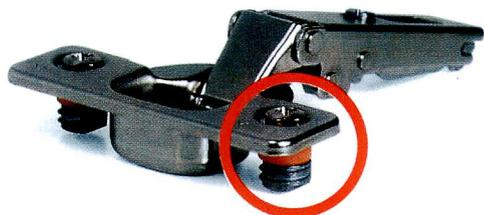
ラピドシステムとは、サリチェ社が開発した画期的なカム式ダボによる、強力かつ簡単なヒンジ取り付けシステムです。
