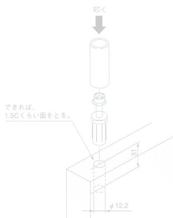
P型ピボットを打ち込むときは、内径φ16くらいのパイプを使って、木製かプラスチックのハンマーで打ち込んで下さい。
