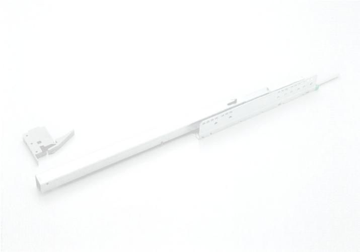
N650は、底付けタイプの完全スライド抽斗レールです。抽斗が完全に閉まる少し前から自動で引き込むように閉まるソフトクロージングタイプと、抽斗を押す事で、自動的に出てくるプッシュタイプがあります。使い方に応じてお選び下さい。
