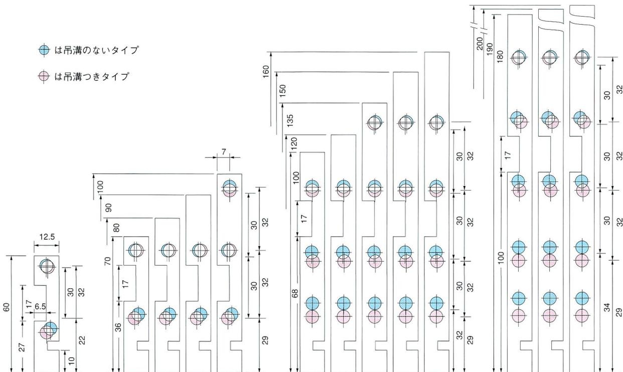
※吊溝のないタイプも寸法は共通です。底板の溝は3mm・3.5mm・4mmが有ります。
