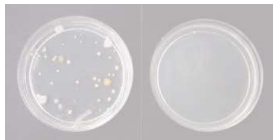
処理前細菌 処理後細菌 安定化二酸化塩素による 空気中の細菌削減効果試験
