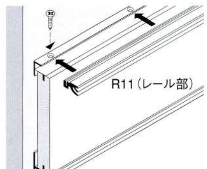
その後、レール部を差し込み上からビスで固定して下さい。
